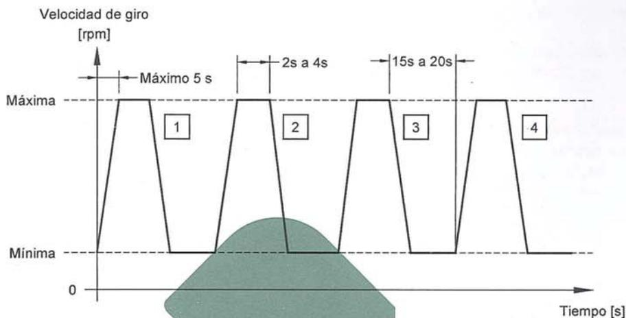
Figura 1. Prueba unitaria de aceleración
